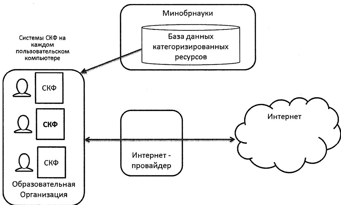
Рисунок 3. Схема работы контент-фильтрации при размещении в ОО
