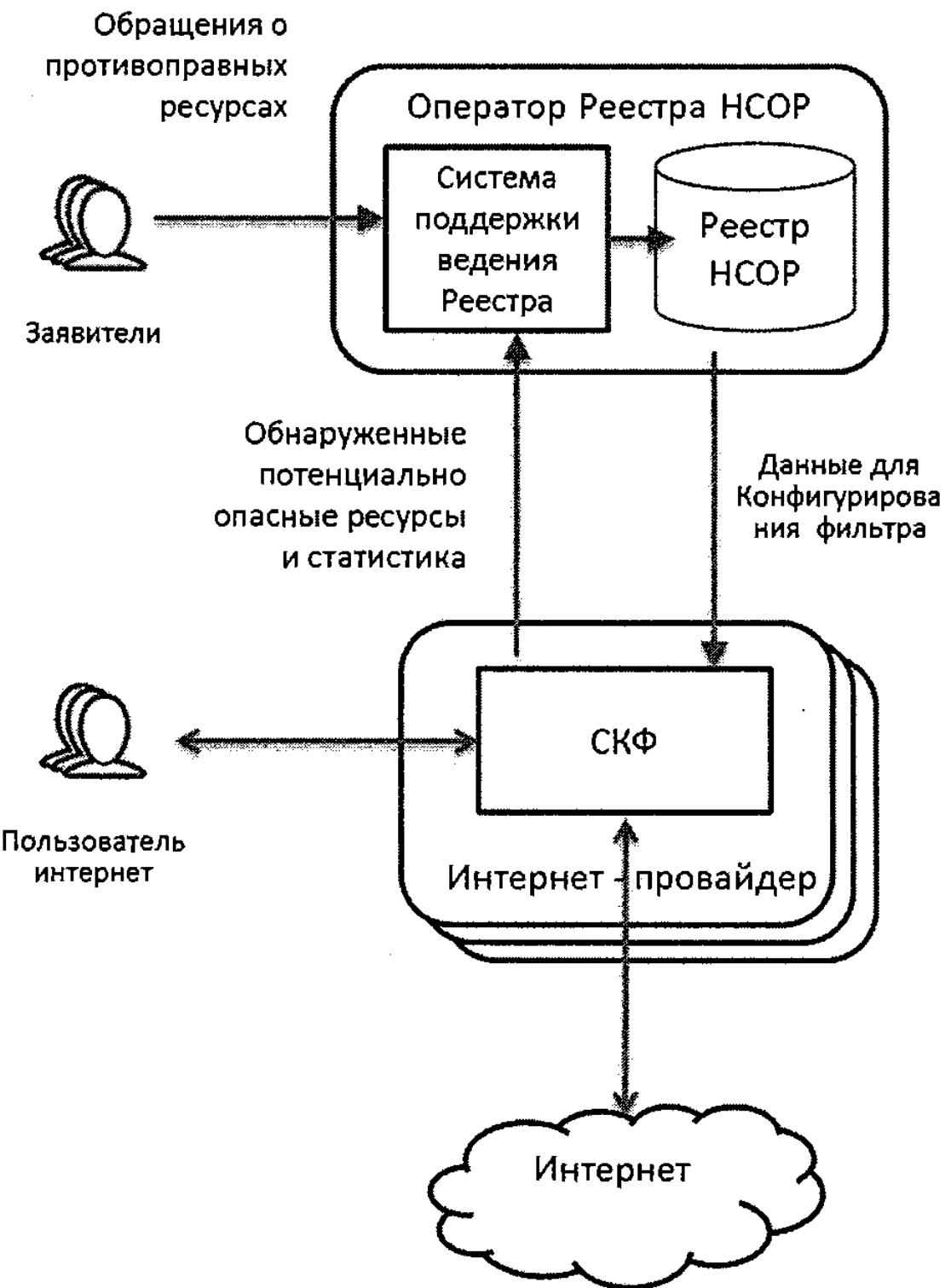
Рисунок 6. Принцип контроля доступа через Реестр НСОР
