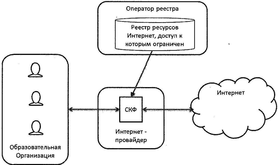
Рисунок 4. Схема работы контент-фильтрации при размещении у Интернет-провайдера
