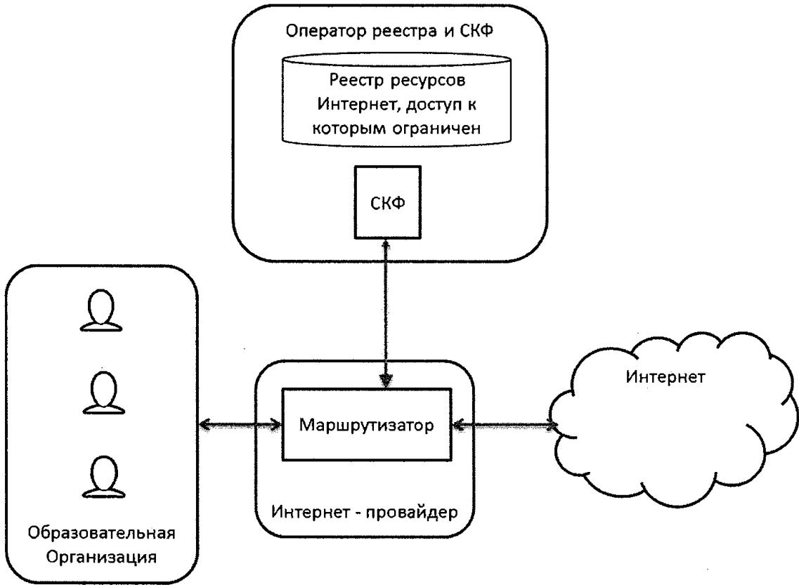
Рисунок 5. Схема работы контент-фильтрации при едином решении
